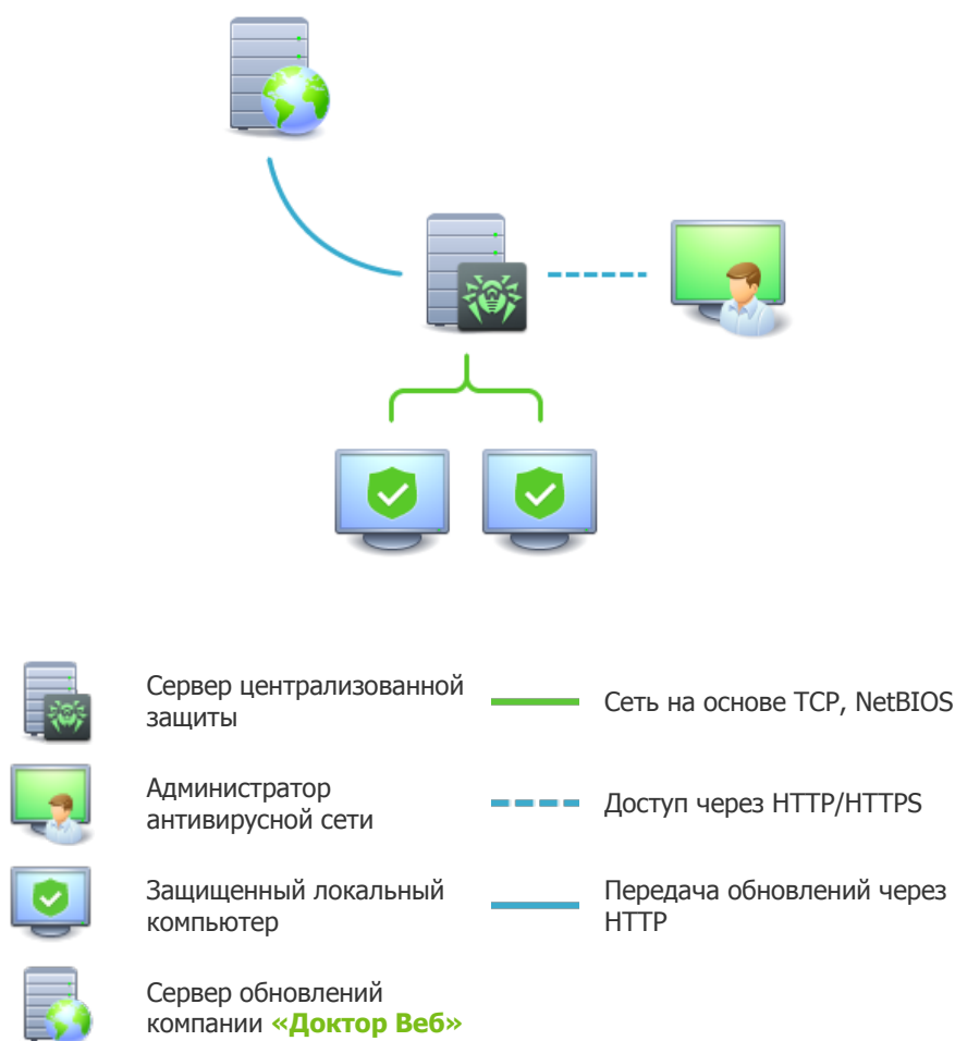
Рисунок 1. Логическая структура антивирусной сети.
